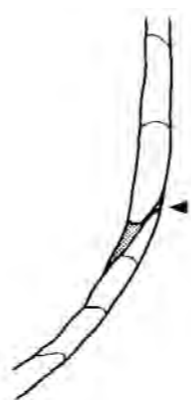
接合部の粘土充填模式図 (アミカケが充填した粘土)
